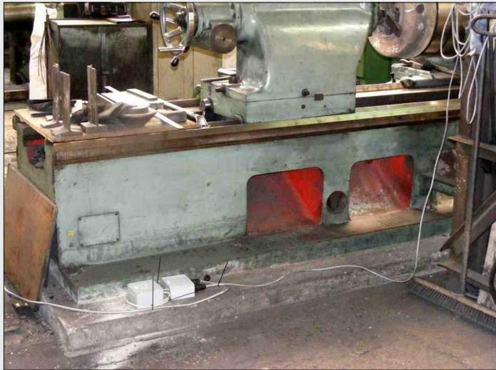
*g-Sensor und AD-Wandler auf Fundament Drehmaschine*
